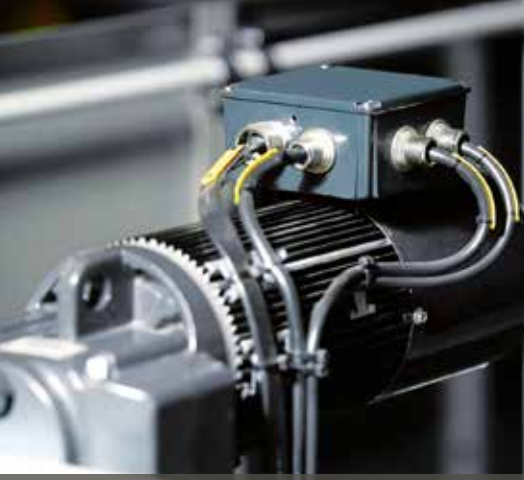
PLIOTEX tipi halat markalama ile kedi yürütme motoru
