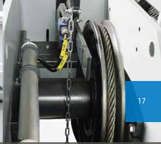
Kolay erişilebilen makaralar ve kanca kontrollü üst limit sivici
