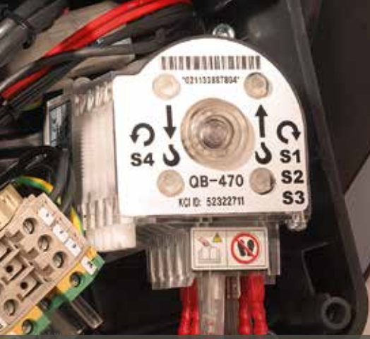
Kaldırma dişlisi limit şalteri
